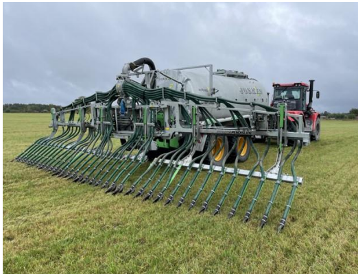
Рис. 1. Интеллектуализированные машины с низкоэмиссионными рабочими органами для внесения жидких органических удобрений на испытаниях в АО «ПЗ «Первомайский» Ленинградской области
