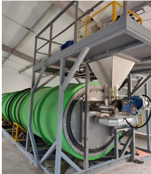
Рис. 2. Автоматизированный биоферментатор для утилизации органических отходов (разработчик ИАЭП-филиал ФГБНУ ФНАЦ ВИМ)
