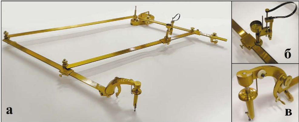
Рис. 4. Пантограф «Г. Белая и Сынъ», середина XIX в. (а); чертёжное устройство с плоской пружиной (б); копировальный узел с системой блоков и рычагом (в). Из коллекции музея МГТУ им. Н.Э. Баумана.
